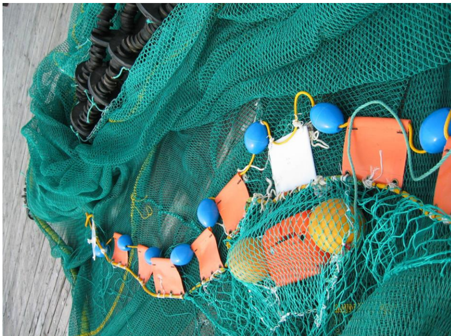
Figur 16. Løfteplater (25X25cm) mellom en ekstra telne kuletelnen og med eggformede kuler tredd innpå den eksta telnen.
